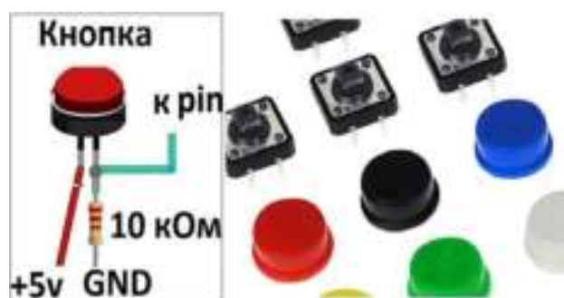
Рис. 1. Схема подключения тактовой кнопки к микроконтроллерной плате
